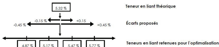
Figure III.4 – Exemple de choix des teneurs en liant en vue de l'optimisation par la compactibilité.
