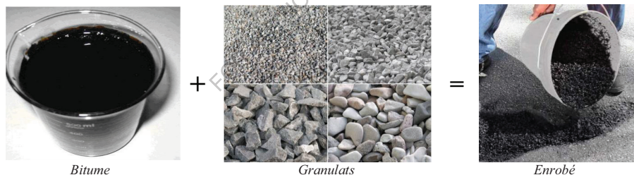
Figure III.1 – Composition d'un enrobé utilisé principalement pour les couches de roulement.
