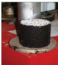
Figure III.10 – Epreuve après confection pour soumettre l'essai Marshall.
