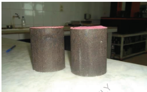
Figure III.12 – Epreuve après confection pour soumettre l'essai Duriez.
