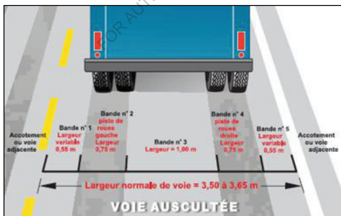
Figure I.1 – Détails des bandes d'auscultation pour la fissuration (dégradation) (MTQ-AIMO 2002).
