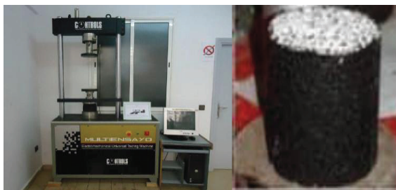
Figure III.7 – Machine de l'essai Duriez avec l'exemple d'une éprouvette confectionnée.
